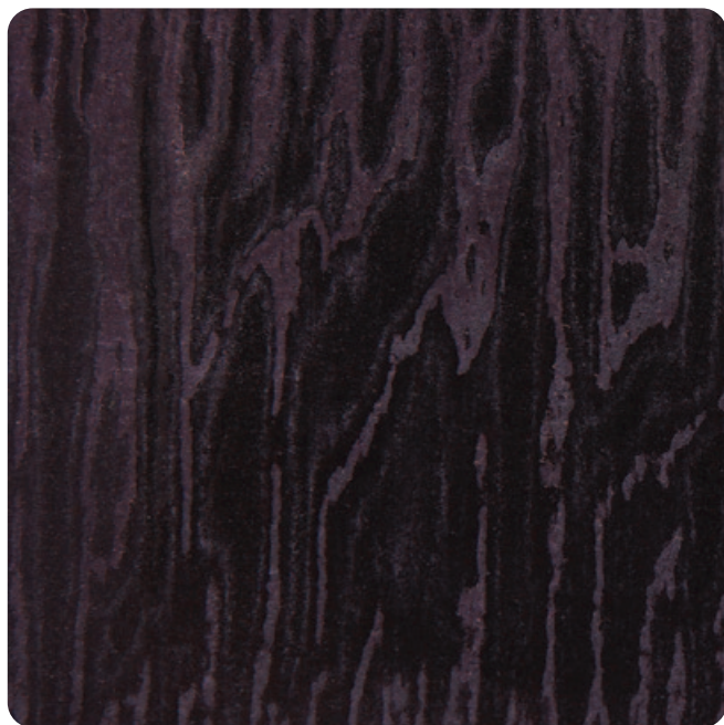
Температурные разводы с нарушением целостности ламинированного покрытия
